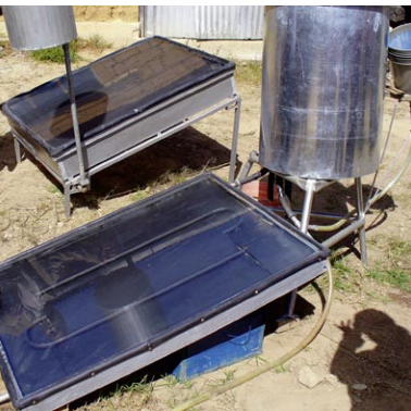
Anlagen zur Aufbereitung von warmem Wasser mit Hilfe der Sonne.
